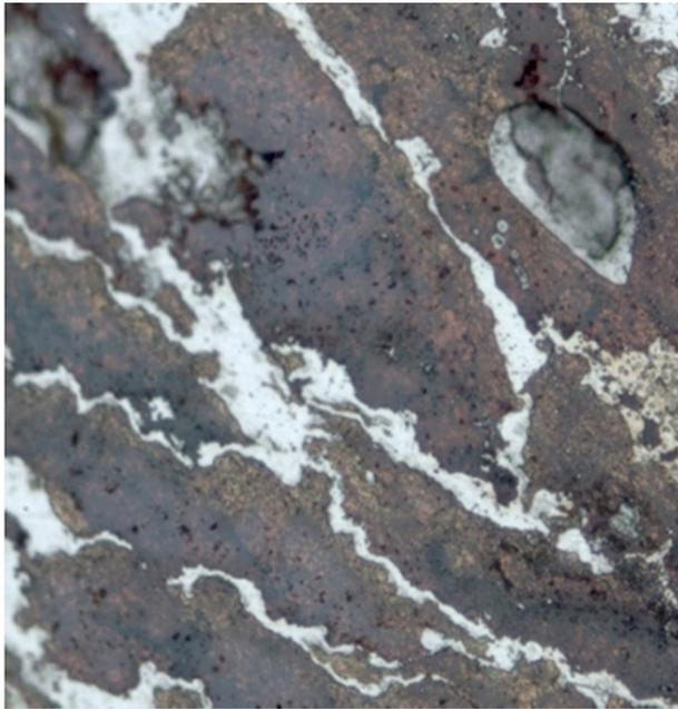
Figura 9. Microestructura de unas pinzas prehispánicas de aleación cobre (76%)-plata (24%). Los granos de fase  $\alpha$  primaria se encuentran corroídos. Mientras que el bifásico, más rico en plata, ocupa los límites de grano y se encuentran intactos, confirmando estabilidad a la pieza. Micrografía X500, campo claro, sin atacar.
