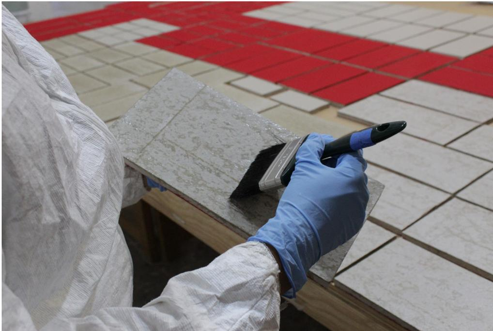
Figura 2. Detalle del proceso de aplicación de los recubrimientos sobre el soporte de fibrocemento para la elaboración de las reproducciones. Imagen: ©María Isabel López Arvizu.
