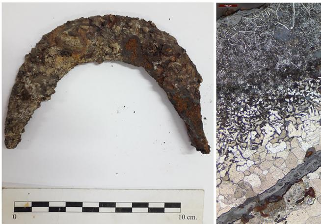
**Figura 2.** Carburado intencional de una hoja de una hoz. El espesor de la capa carburada que aparece en el exterior, en color gris oscuro, es de más de 300  $\mu\text{m}$ . Micrografía X200, campo claro, atacada con Nital.
