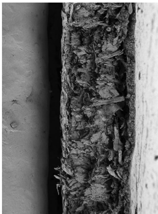
Figura 3. Corte transversal de copia en papel, proceso gelatina de plata (1914) observado por microscopía electrónica de barrido (Microscopio Zeiss Supra 55VP – Centro Integral de Microscopía Electrónica, 9 de diciembre de 2020)
