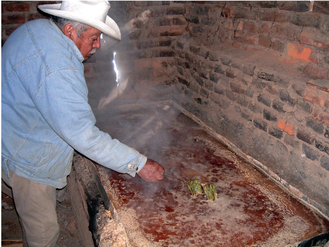
Don Sebastián Nopaltitla removiendo tiras de nopal para la cristalización de la paila donde prepara sal blanca. San Cristóbal Nexquipayac, Atenco, Estado de México, abril de 2006. © Fotografía: Blas Román Castellón Huerta.
