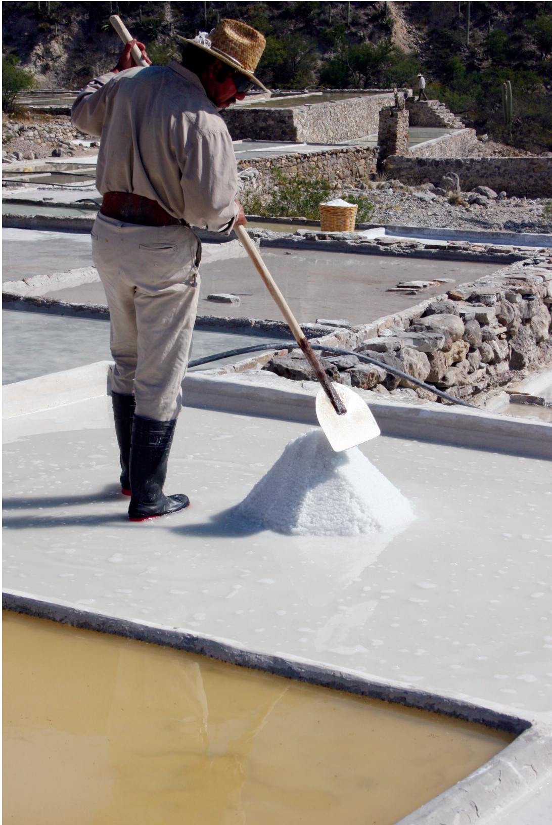
El Sr. Vicente Rivera formando el cono de sal para escurrirla. Salinas Las Grandes, Zapotitlán Salinas, Puebla, noviembre de 2007. © Fotografía: Blas Román Castellón Huerta.
