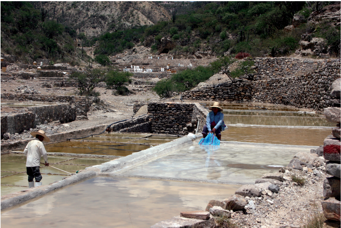
Lavando la salina y removiendo el polvo con bolsa. Paraje Las Grandes, Zapotitlán Salinas, Puebla, julio de 2016. © Fotografía: Blas Román Castellón Huerta.
