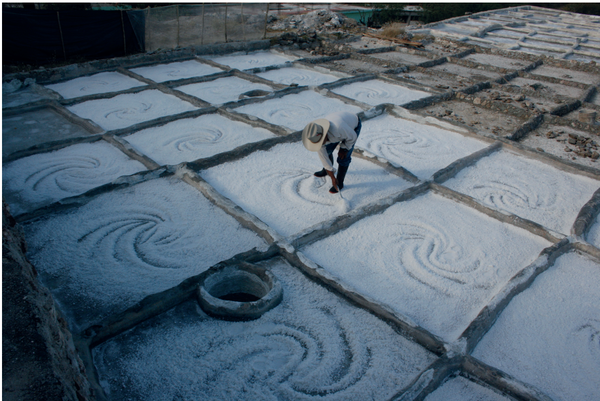
Moviendo la sal con machete para secarla. Salinas de San Pedro Ocotlán, Chila de la Sal, Puebla, diciembre de 2008. © Fotografía: Blas Román Castellón Huerta.
