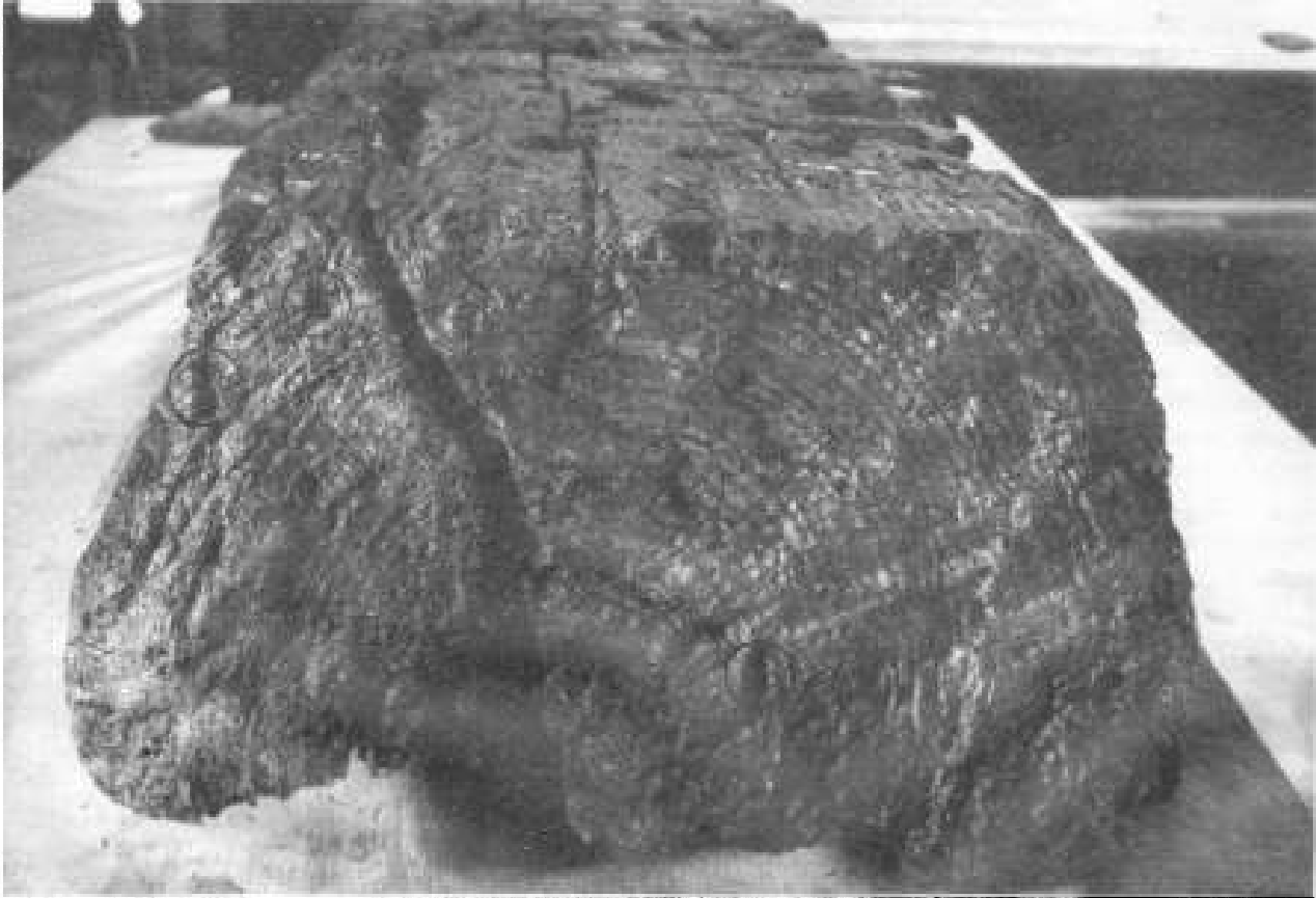
Fig. 1. Dintel núm. 1. (R-4; U:41; elemento núm. 1, pieza núm. 1092; clave: DRPC 248 92; largo: 1.87-1.92 m. ancho: 0.40-0.56 m. alto: 0.21-0.23 m.) Sobre el plano transversal del lado derecho de la grieta se observan en forma marcada los anillos de crecimiento; las áreas delimitadas muestran los túneles construidos por las termitas. Sobre el relieve del plano tangencial se aprecian grietas y colonias esféricas representadas por hongos de color blanco, solitarias y agregadas linealmente.
