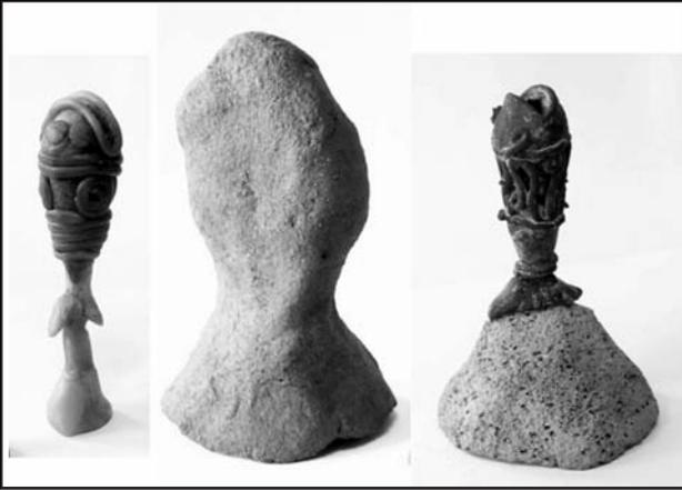
Fotografía 2. Trabajo experimental. (Diseño de cascabel en cera, molde de barro y diseño transformado en plata).
