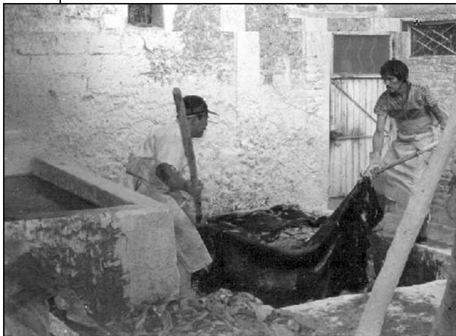
Figura 4. Descarnadores sacando los cueros de las pilas con la ayuda de ganchos. Foto: Martha Hernández Cáliz.
