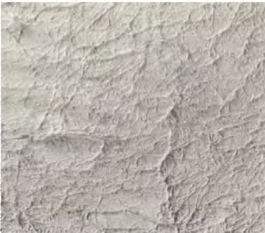
FIGURA 2. PERGAMINO NUEVO DE CABRA. SOBRE LA CAPA RETICULAR FIBROSA SE OBSERVA UNA TRAMA CERRADA COMPUESTA POR FIBRAS PROTEICAS DE COLÁGENO Y ELASTINA
