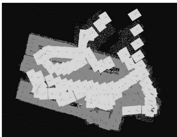
● Fig. 24 Los cuadros más oscuros representan la posición de las cámaras del primer vuelo; los de tono más claro son del segundo vuelo.
