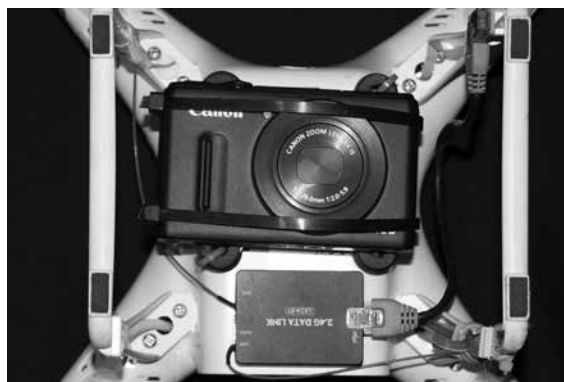
Fig. 5 Cámara Canon S100 y terminal aérea del módulo DataLink montados en el VANT.
