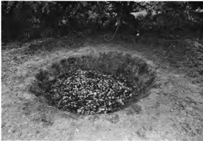
● Fig. 7 Horno actual para producción de mezcal, San Luis Amatlán, Oaxaca.
