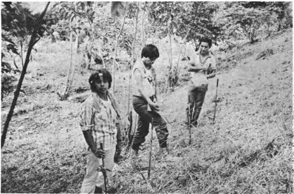
Foto 8 Lecturas de resistencia eléctrica en el módulo 9, en la esquina sureste de la estructura C-1
