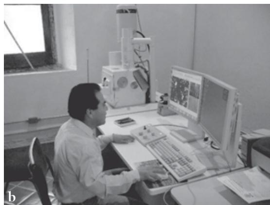
● Fig. 4 (a) Microscopio estereoscópico y (b) microscopio electrónico de barrido.
