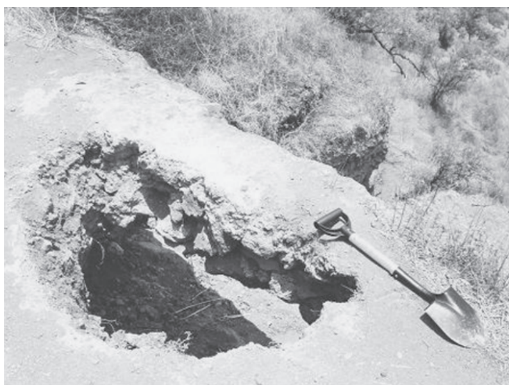
● Fig. 11 Formación de oquedades sobre la superficie del terreno. En este caso agrandada por la actividad humana.
