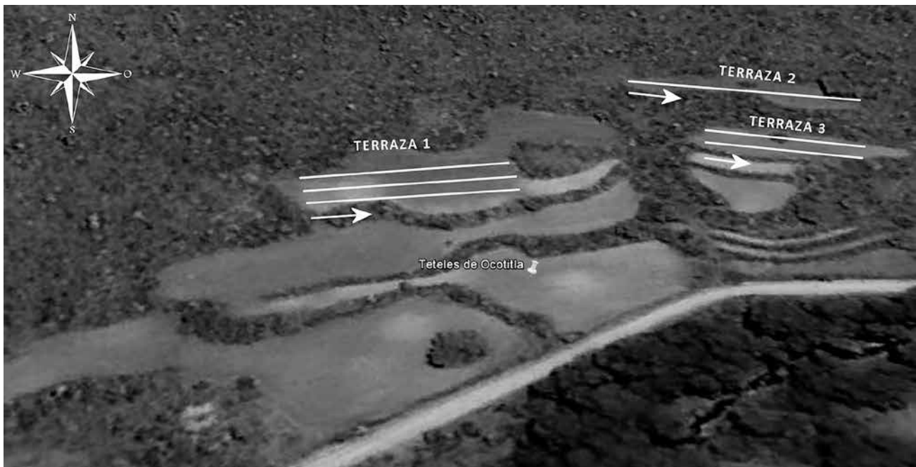
Fig. 3 Terrazas prospectadas con el método de tomografía eléctrica. Las líneas blancas marcan la posición de las líneas eléctricas levantadas. Las flechas blancas marcan el sentido en el que se levantaron los datos eléctricos. Fuente: modificado a partir de imagen de satélite obtenida de Google Earth (© 2015 Google Inc.).
