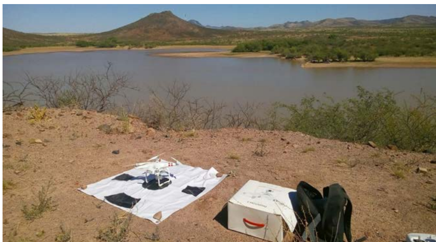
Fig. 4 Dron y targets de mayor tamaño para la georreferenciación del sitio.
