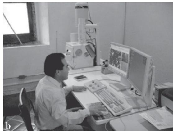
● Fig. 4 (a) Microscopio estereoscópico y (b) microscopio electrónico de barrido.
