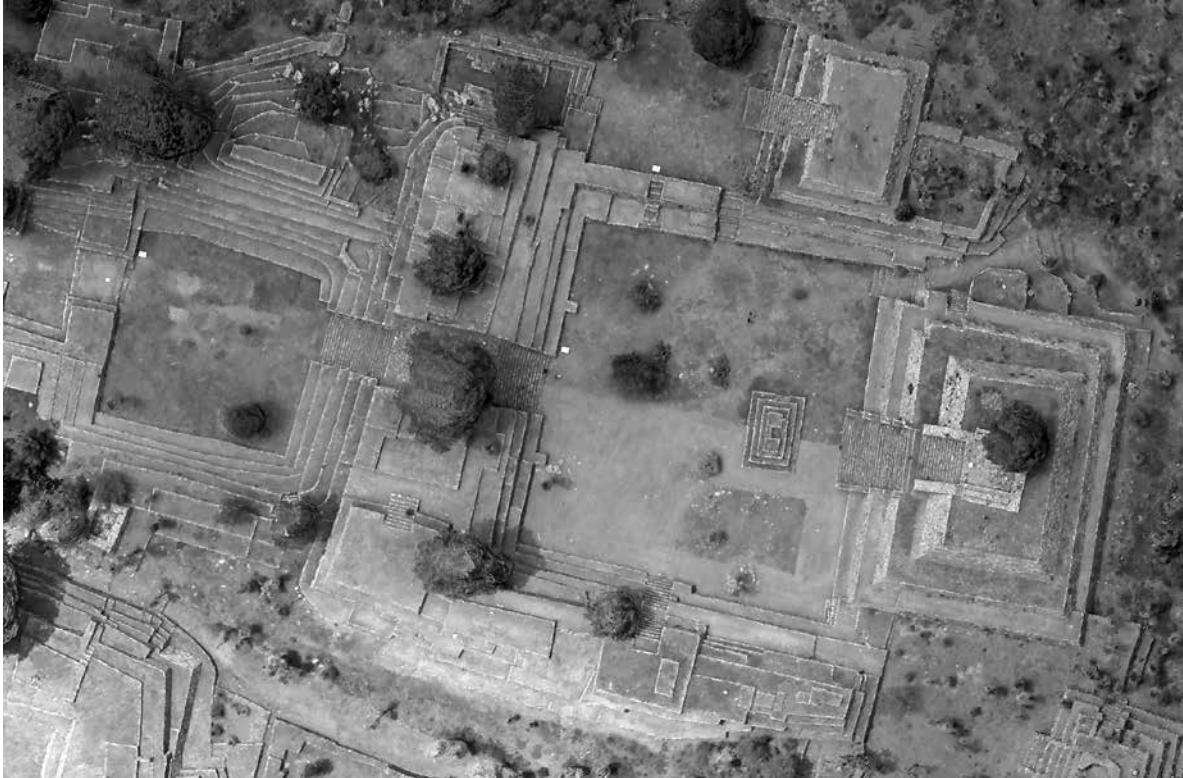
© Fig. 3 Ortofoto producida con fotogrametría, producto de imágenes recopiladas por un VANT, base para el levantamiento mostrado en la figura 2.
