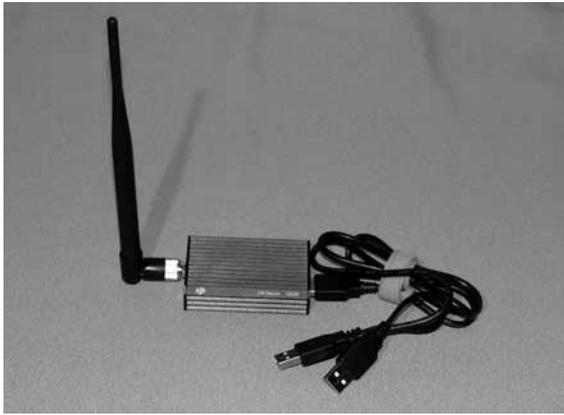
Fig. 8 Terminal terrestre del módulo *DataLink*.
