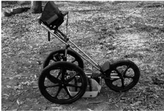
● Fig. 5 Radar de penetración (GPR) para el sondeo del subsuelo. Equipo de Bioarqueología.
