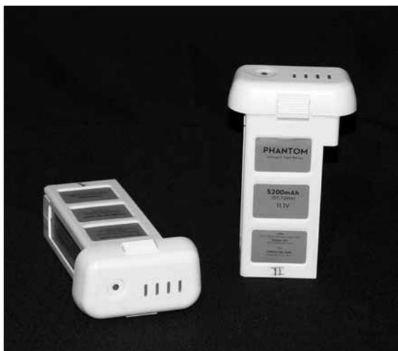
Fig. 3 Baterías de polímero de litio (LiPo) utilizadas por algunos VANT.
