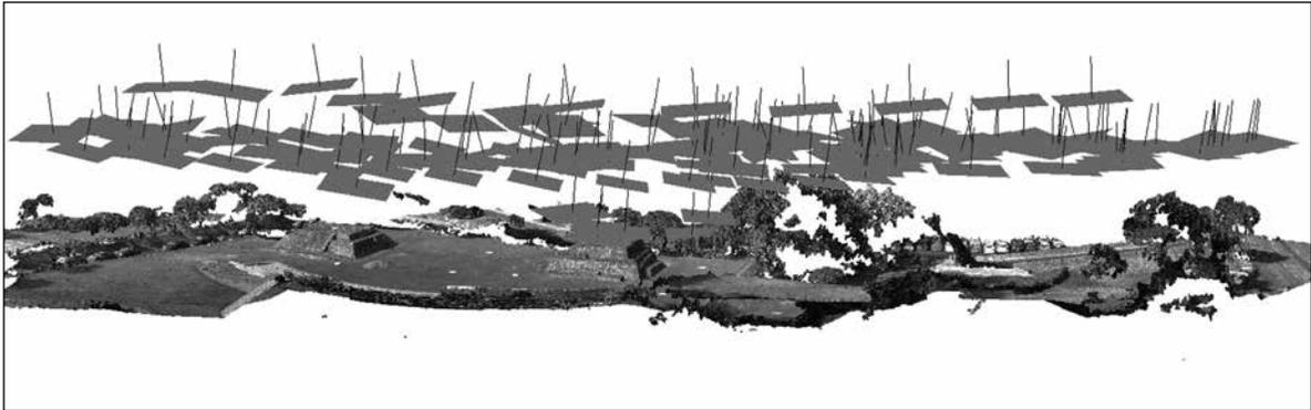
● Fig. 21 Cuiculco B. Vista oblicua alta de la nube de puntos densa, en la parte superior está representada la posición de las tomas realizadas por la cámara montada en el VANT.
