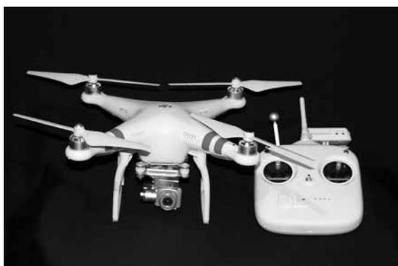
Fig. 4 Modelo *Phantom 2 V.3 Vision +* con cámara integrada.
