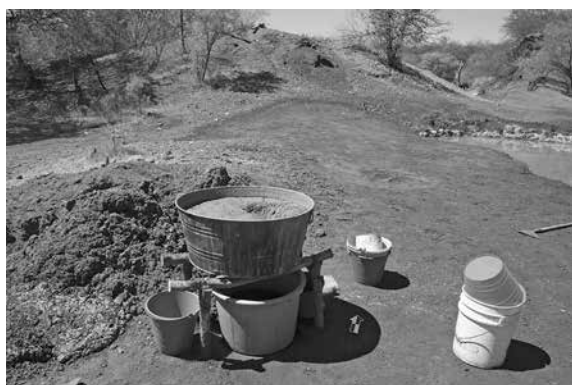
● Fig. 7 El Salitre, Guerrero. Mecanismo simple para lavado de tierras saladas, a un lado la acumulación de tierras lixiviadas, y al fondo el terrero y el pozo, marzo de 2009. Foto de B. Castellón.
