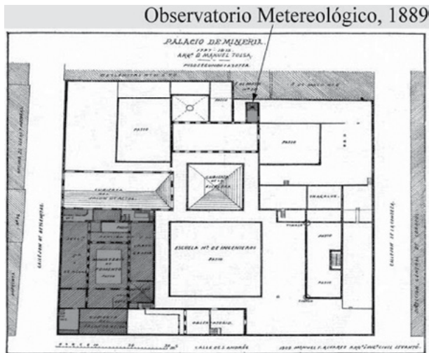
Figura 1. Azotea del edificio de Minería; a la izquierda las obras realizadas por la Secretaría de Fomento entre 1906-1909; a la derecha el Observatorio Meteorológico de 1889. Plano de azotea levantado por Manuel Francisco Álvarez. Dichas obras fueron demolidas en la intervención de 1970-1976. Manuel Francisco Álvarez, El Palacio de Minería, México , Secretaría de Instrucción Pública y Bellas Artes, 1910. Diseño de Juan Ramón Rodríguez Covarrubias
