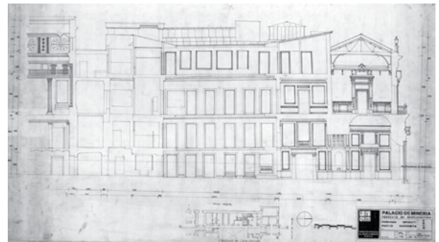
Figura 2. Corte norte-sur; se aprecian los cuatro niveles (planta baja, entresuelo, primer nivel y azotea con sus agregados). Se observa el grado de inclinación del edificio hacia el sur. Archivo Histórico del Palacio de Minería (AHPM).
