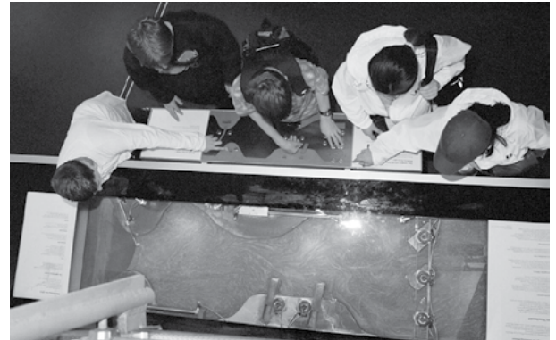
Figura 13. En esta demostración se hacen visibles los flujos de agua y los efectos provocados por instalaciones hidráulicas en el cauce. Fotografía del Deutsches Museum.
