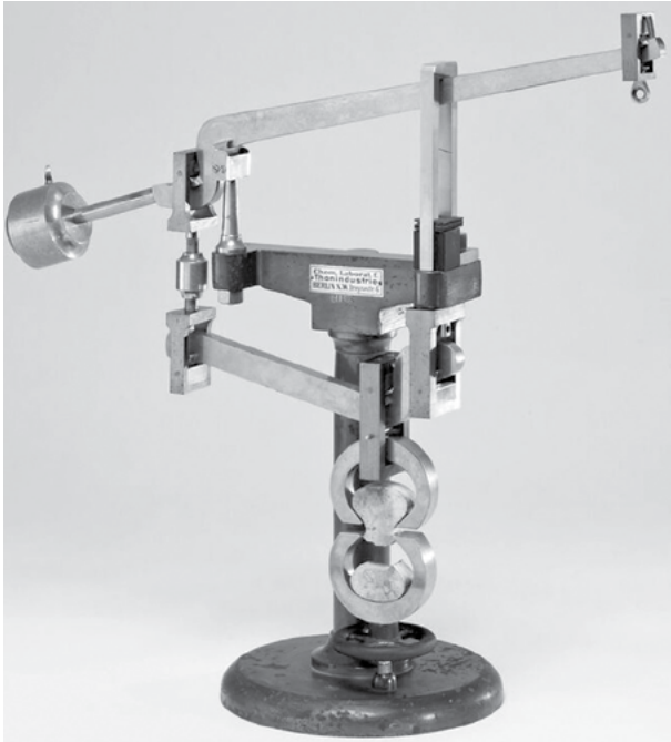
Figura 3. El popular examinador de cemento estándar de Wilhelm Michaelis de 1876. Fotografía del Deutsches Museum.
