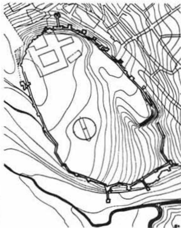
La Alcazaba de Badajoz, construida c.1150 y demolida en el siglo XVII. Obsérvense las torres albarranas, separadas de las murallas, pero ligadas a ellas, así como los vestigios de la barbana (Torres Balbás).
