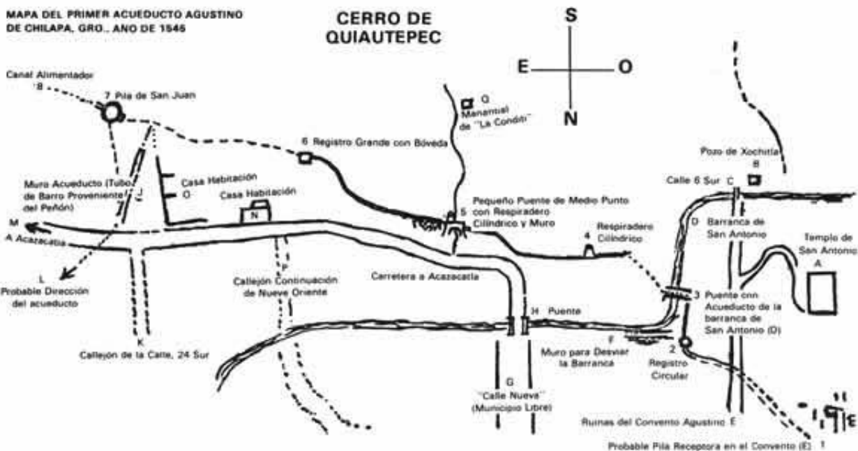
Figura 4. Principales puntos de la reconstrucción que realizó Angarito Hernández (1989) del acueducto agustino de Chilapa, con base en las ruinas existentes todavía dentro de la población.
