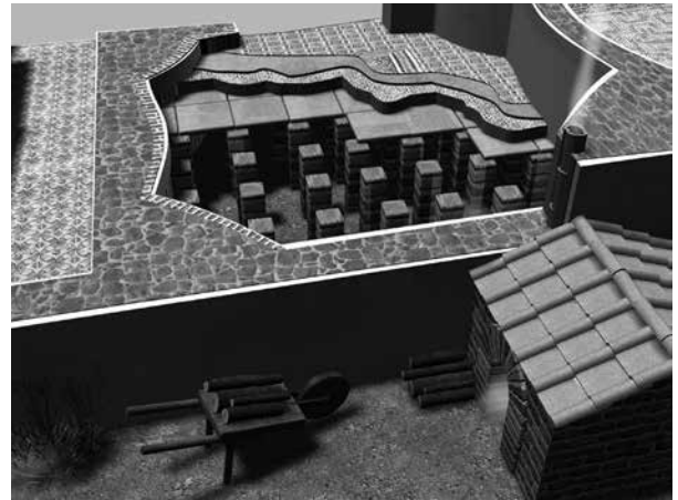
Figura 20. Cubiculum. Hipocausto. Parque arqueológico de Carranque, Toledo. Reconstrucción en 3D: Balawat, Esther G. Domínguez y Belén Patón Lorca.
