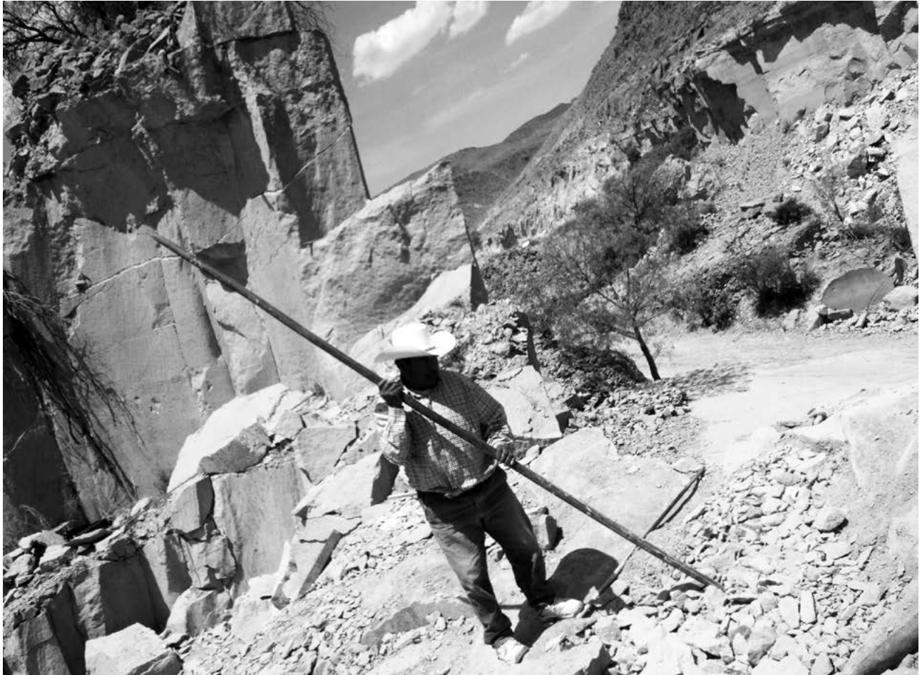
Figura 5. "Cortador" sujetando una barra para fisurar o diaclasar la piedra para hacer un barreno, en el cual será injertada la pólvora o la cal que ayudará al desprendimiento final de la piedra. Cantera La Cueva, al sur de la ciudad de San Luis Potosí. Fotografía de Rocio Ivet Oros Guel, mayo de 2015.
