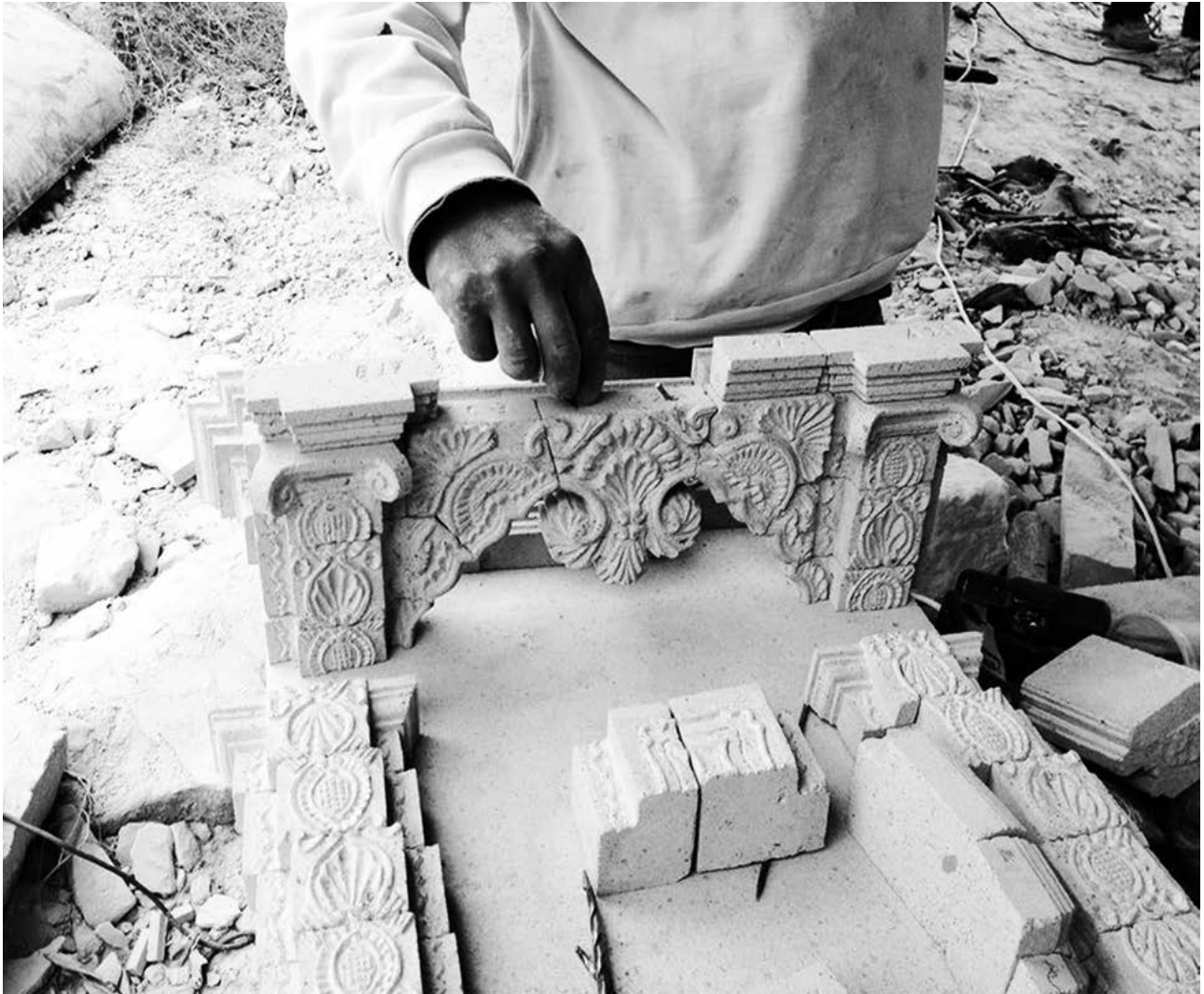
Figura 13. Se observa la habilidad del maestro cantero al realizar el trazo geométrico preciso del elemento a tallar; esta precisión se demuestra en el momento del ensamblaje. Fotografía de Rocío Ivett Oros Guel, diciembre de 2015.
