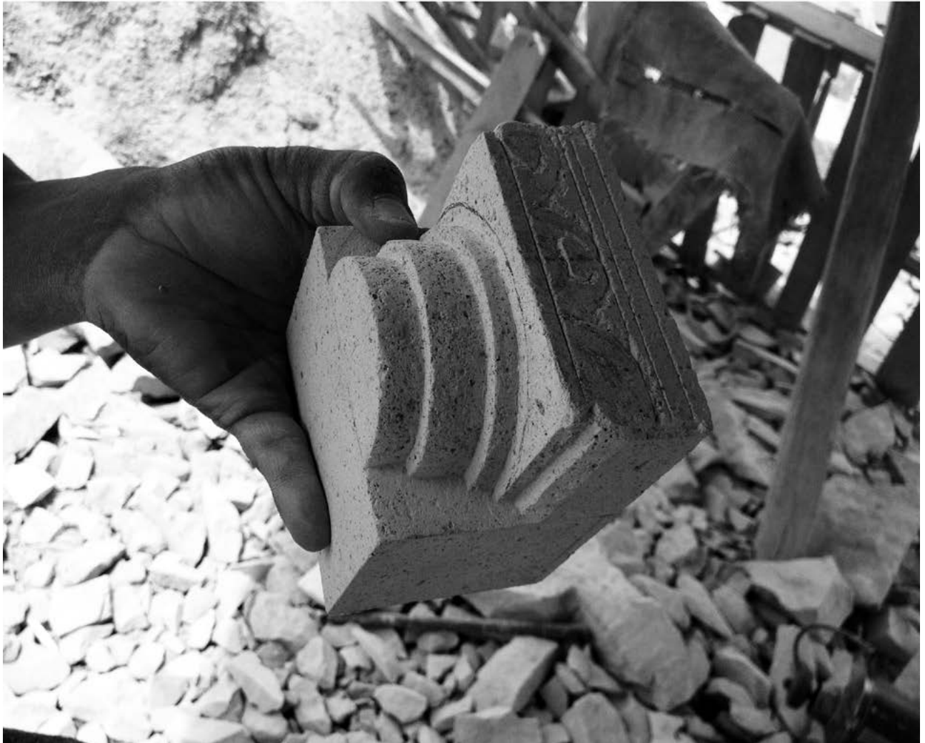
Figura 10. En el proceso de la "talla" se empieza a desbastar o retirar el material de acuerdo con estratos o niveles, empezando a definir con el nivel más profundo. Este procedimiento se observó en Escalerillas, San Luis Potosí. Fotografía de Rocío Ivett Oros Guel.
