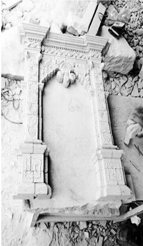
Figura 14. A la izquierda se aprecia el terminado final de la pieza, en la que se definieron los más pequeños detalles, el acabado terso por medio de esmeriles y la limpieza con cepillos y esponjas húmedas. En la parte central y derecha se observan imágenes en 3D del ensamblaje estereotómico, que evoca una armonía constructiva-estructural trascendente. Fotografías de la tesis de doctorado de la autora, 2016.
