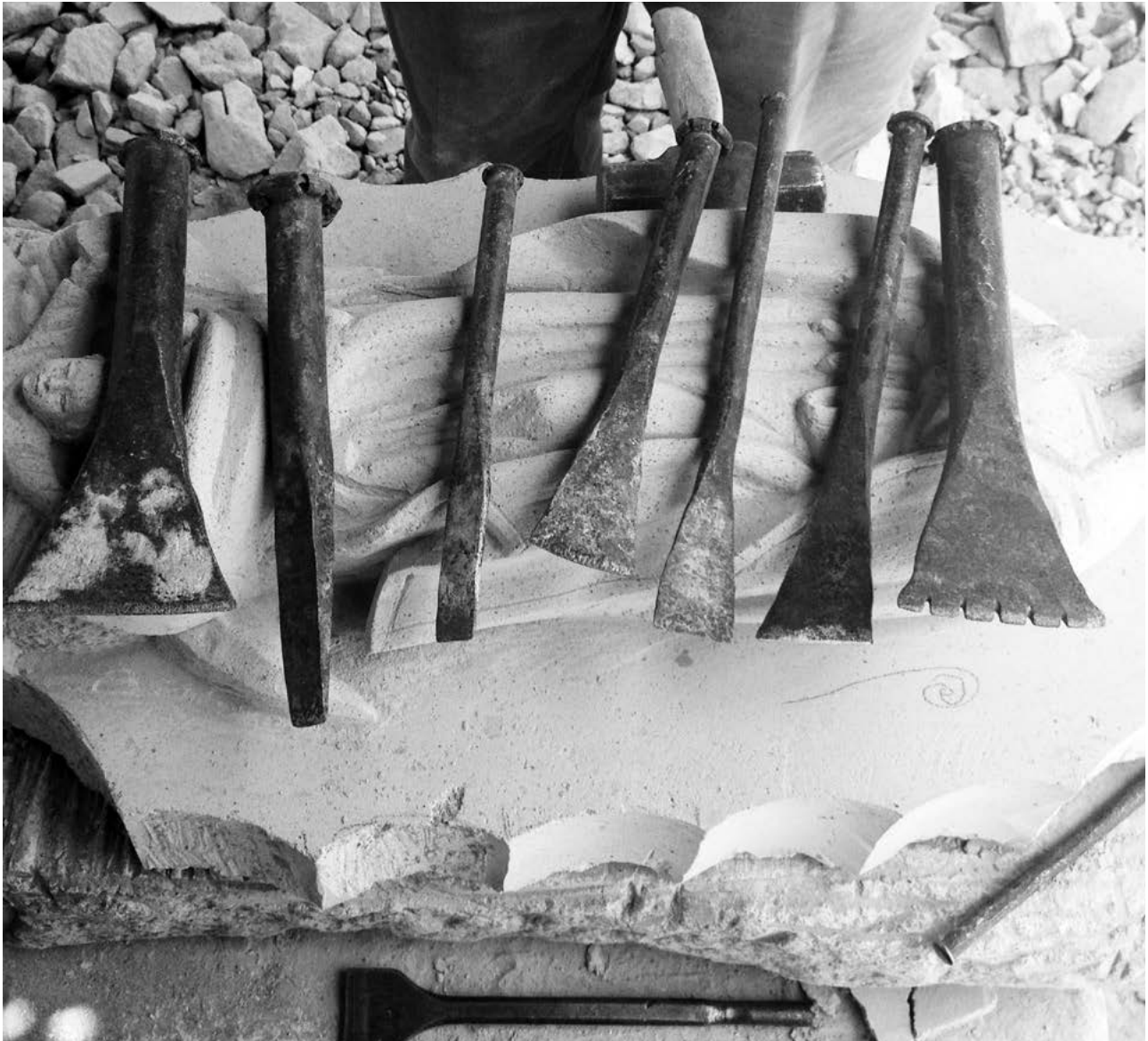
Figura 11. Herramientas utilizadas por los canteros de San Luis Potosí, similares a las presentadas en la imagen estudiada de Sahagún; entre ellas se identificaron, de izquierda a derecha: bocón o máquina, dos cinceles, dos escoplos y dos gradinas o “perros”. Fotografía de Rocío Ivett Oros Guel, abril de 2015.
