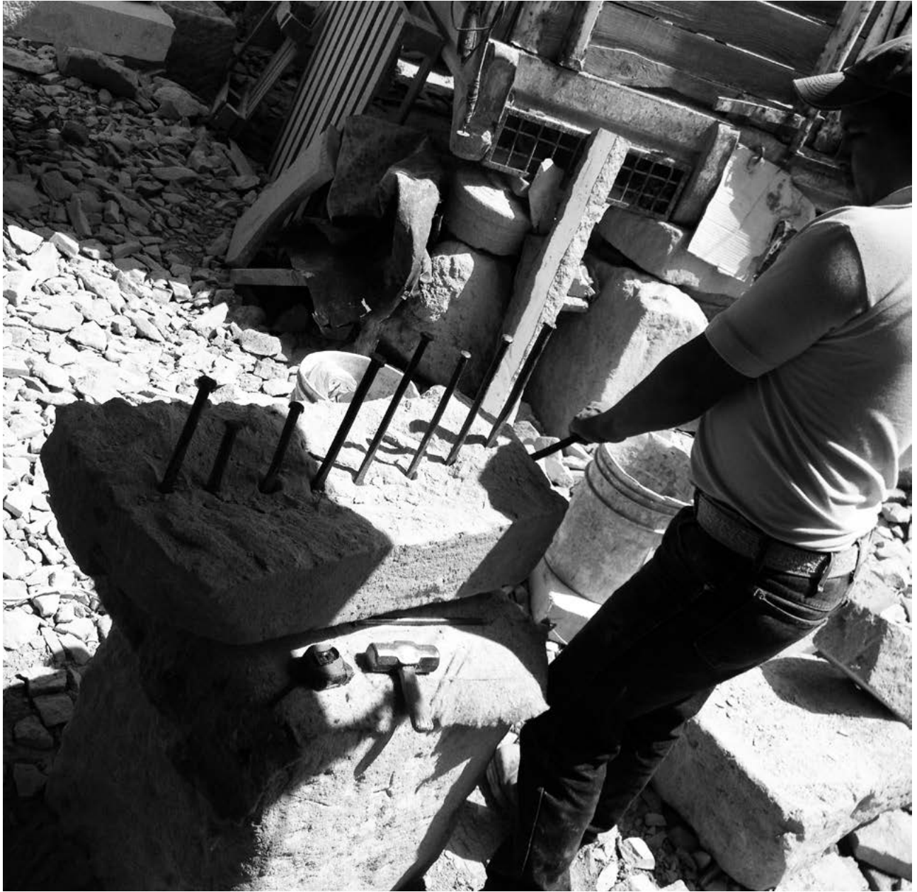
Figura 8. La actividad de “cuñear la piedra” implica colocar cuñas o cinceles con una separación de 10 cm y golpear cada uno de ellos, separando los bloques de una manera lineal. Fotografía de Rocío Ivet Oros Guel, 15 de abril de 2015.
