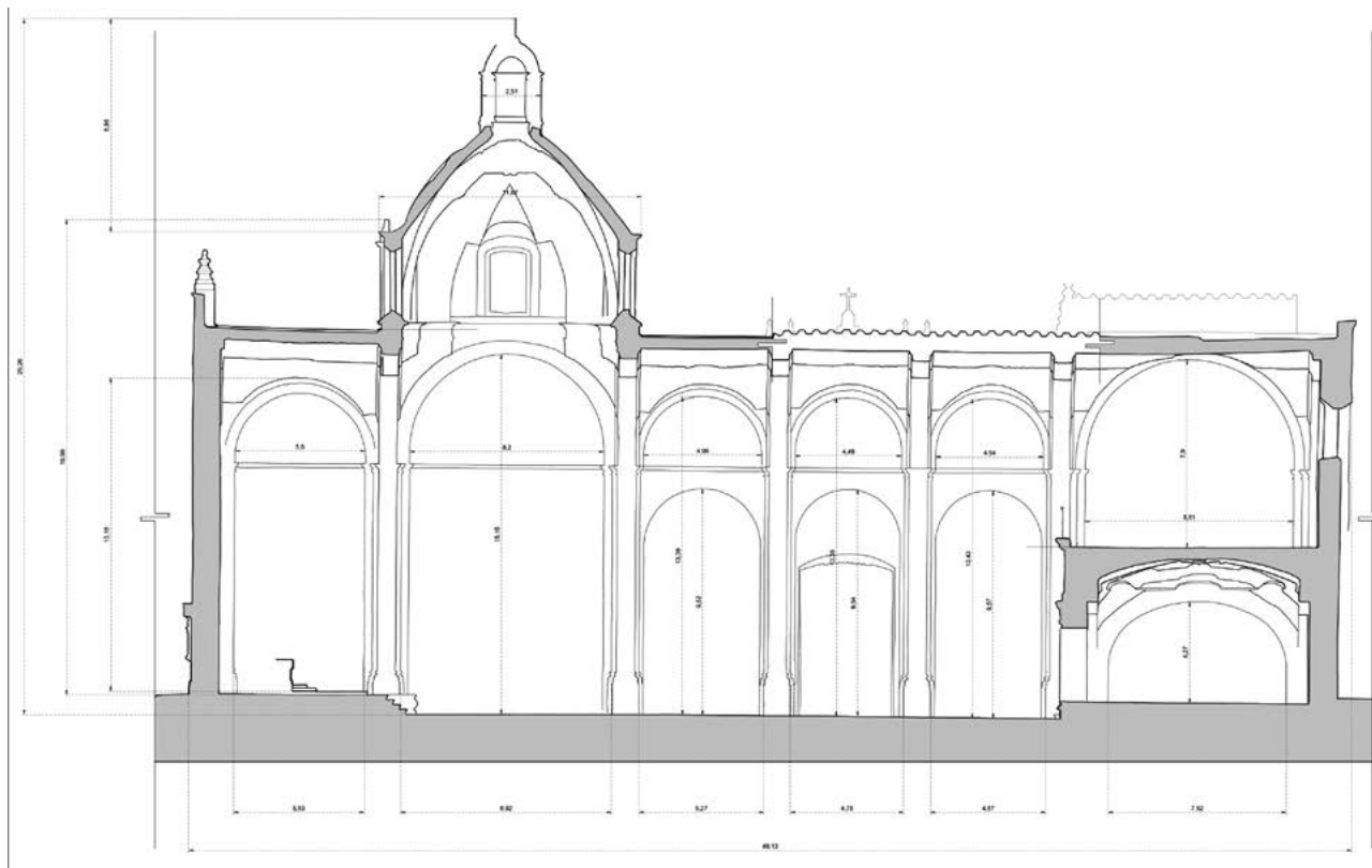
Figura 13. Corte del templo, sección A-A', resultado del escaneo en láser. Elaborado por la CNMH-INAH.
