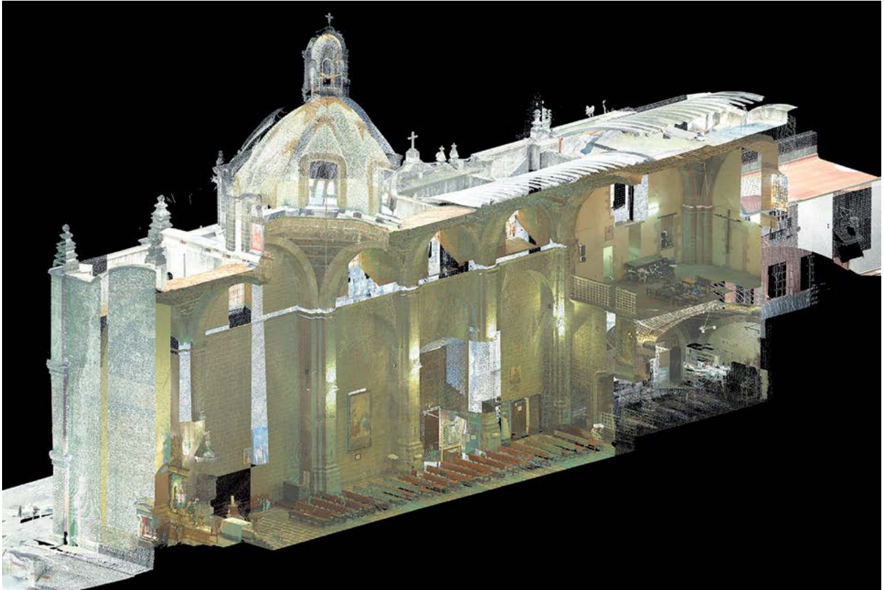
Figura 14. Corte arquitectónico del templo, donde se observan detalles de la bóveda de tezontle, muros, techumbre, etc., en nube de puntos con fotografía. Levantamiento en escáner Láser 3D realizado en el IAD-CNMH-INAH. Trabajo elaborado en 2015.
