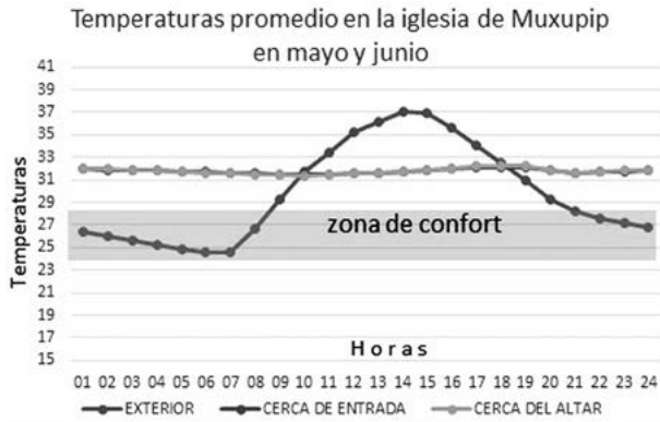
Gráficas 5 y 6. Variabilidad de la temperatura y la humedad, respectivamente, en un día promedio de mayo, en el interior de la capilla de Muxupip. Elaboradas por los autores.
