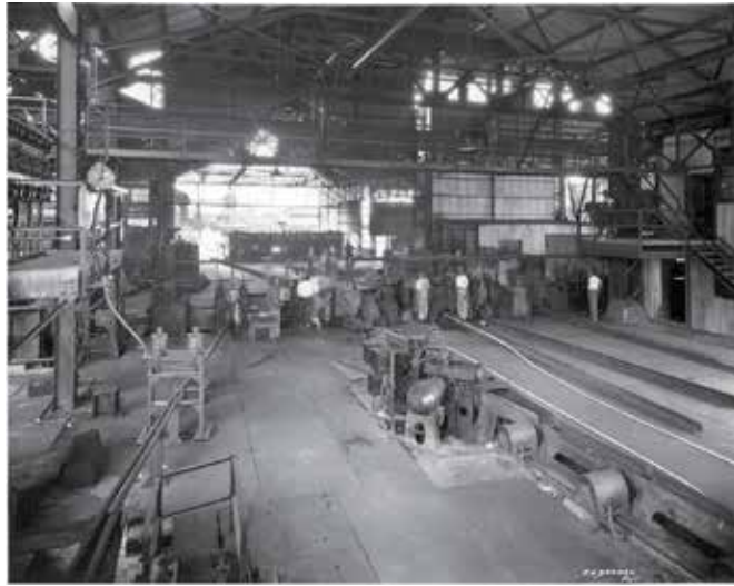
Figura 11. Obreros producen varilla corrugada con los molinos de laminación de 11", ca. 1945. Eugenio Espino Barros, Monterrey, N.L., México. D.R. © 42660 Fototeca Nuevo León-Conarte, Fondo: Fundidora.
