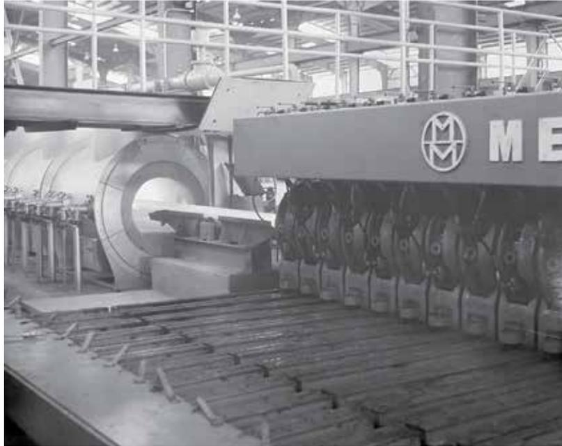
Figura 7. Horno continuo tipo túnel marca Mannesmann Meer, dentro de las instalaciones de la nueva tuna. AHF, Empresas Filiales, Sección TUNA, junio 1972.
