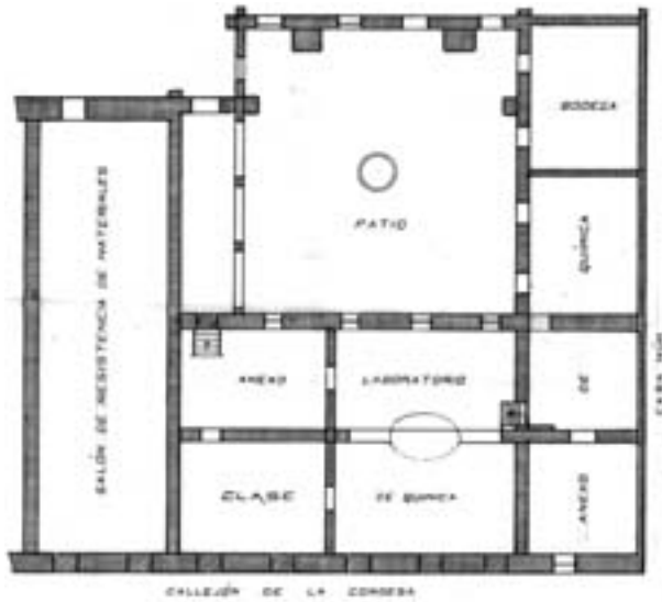
Plano 5. Planta baja de la sección suroeste de la ENI delineada por el ingeniero Luis Salazar en 1897, antes de las modificaciones. Nótese los contrafuertes en la parte superior del patio. FUENTE: AHPM 1897/III/259/d.16, f.3, fragmento.
