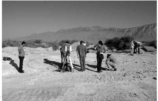
Figura 6. Levantamiento con tecnología escáner láser de 17 huellas humanas fosilizadas. Desierto de Cuatro Ciénegas, Coahuila. 2011.
