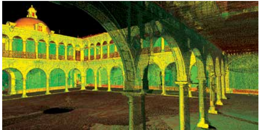
Figura 10. Vista general en nube de puntos con fotografía del claustro del exconvento de La Merced, ciudad de México. 2010.
