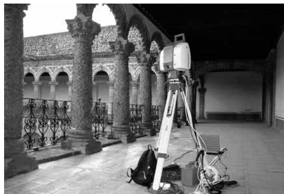
Figura 1. Levantamiento arquitectónico con tecnología escáner láser del claustro del exconvento de La Merced, ciudad de México, 2011.
