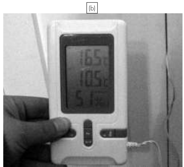
Figura 1. a) La contraventana de madera reduce considerablemente la caída de temperaturas nocturnas. b) Medición durante una noche invernal: la temperatura en la cara que corresponde a la habitación supera en 5 °C a la de la cara que linda con la ventana. Fotografías de René L. Sánchez.
