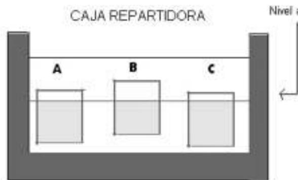
Figura 12. Distinta altura, misma superficie; el agua entra en diferente proporción.
