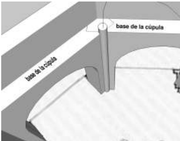
Figura 11. Ilustración de la división del muro en dos partes para recibir la hilada de arranque de la cúpula. Dibujo de Fredy Ovando Grajales.
