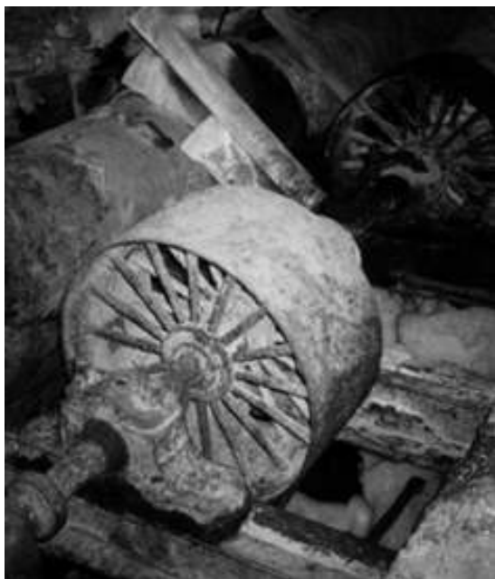
Figura 15. Rueda hidráulica de fuerza motriz. Hacienda "Bellavista", Tepic, Nayarit (ca. 1843). Fotografía de Humberto Morales. Para todo lo relativo a la tecnología manufacturera textil del siglo XIX y la arqueología industrial de Nayarit y Puebla, véase Humberto Morales, "Arqueología industrial y medio ambiente. El ejemplo histórico de la temprana industria textil mexicana en el siglo XIX", en Jaime Migone Rettig et al. (eds.), Puesta en valor del patrimonio industrial, sitios, museos y casos , Santiago de Chile, TICCIH-Chile, 2006, pp. 79-87; Dawn Keremitsis, La industria textil mexicana del siglo XIX , México, SEP (SepSetentas, 67), 1973.
