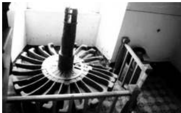
Figura 16. Turbina hidráulica tipo Giffard (ca. 1850) en la fábrica "El Hércules". Querétaro. Fotografía de Daniel Valencia Cruz.
