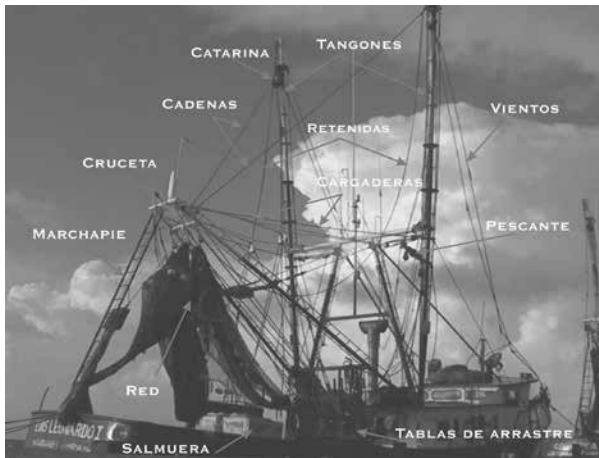
Figura 3. Arboladura de una embarcación camaronera en el muelle de Lerma, Campeche. Foto de Patricia Carrillo/SAS.
