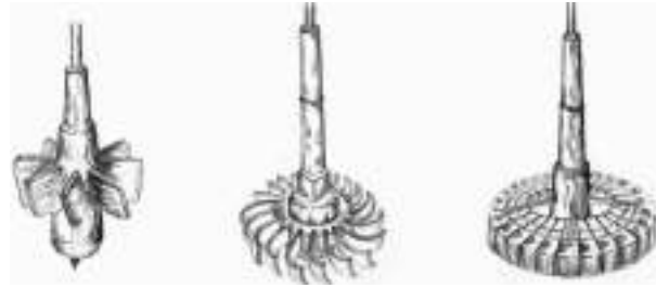
Figura 3. Evolución de las ruedas horizontales o rodeznos. Yolanda Terán Trillo, op. cit. , p. 27.
