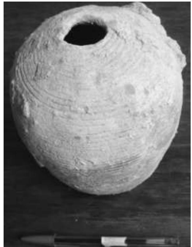
Figura 7. Cántaro de barro utilizado en el aligeramiento de bóvedas en el inmueble. Archivo de la SMH-Centro INAH Colima.
