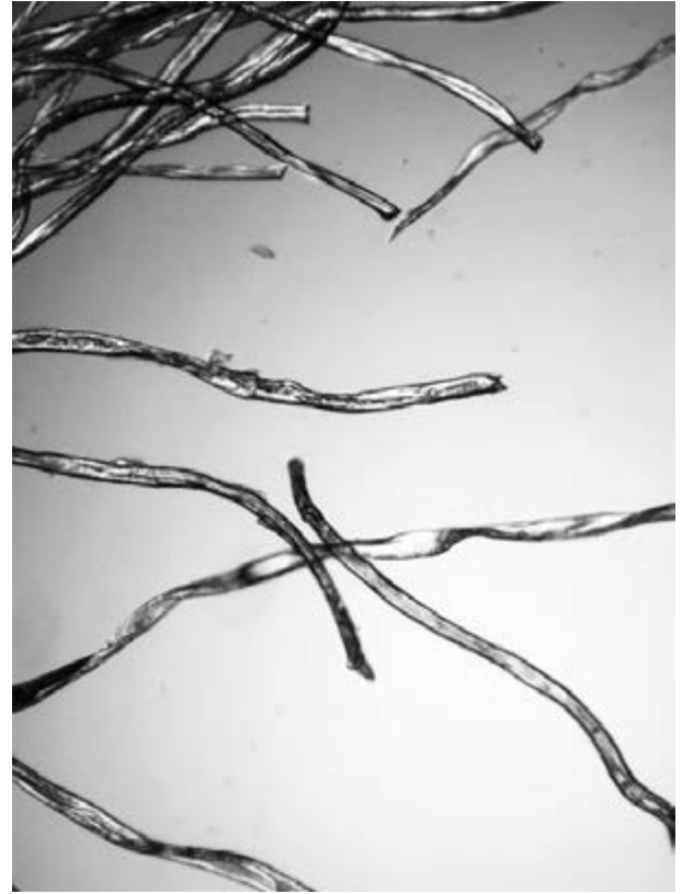
Figura 10. Vista en microscopio biológico en el que se observan las roturas en las fibras de algodón de la entretela. Fotografía del STCR.
