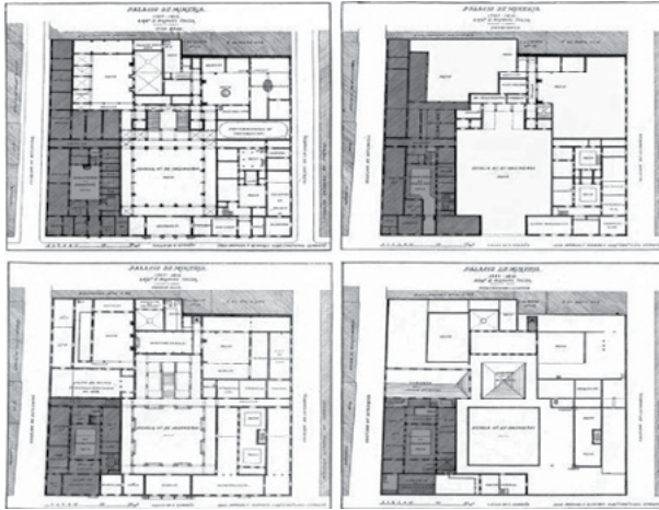
Figura 4. Los cuatro niveles que ocupaba la Secretaría de Fomento en 1909 (30% del edificio). En la intervención de 1970 a 1976 fueron demolidos todos los agregados de la azotea; en esos años salió la que ya era la Secretaría de Agricultura y Ganadería. Manuel Francisco Álvarez, El Palacio de Minería , México, Secretaría de Instrucción Pública y Bellas Artes, 1910. Diseño de Juan Ramón Rodríguez Covarrubias.
