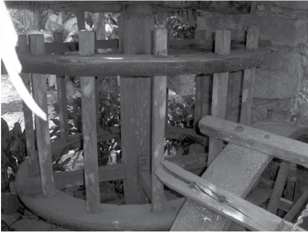
Figura 16. Ruedas horizontal y vertical de la noria del ex convento San Miguel Arcángel en Maní, Yucatán. Fotografía de Manuel Arturo Román Kalisch.
