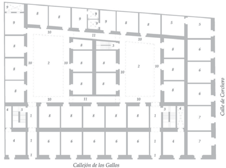
Figura 10. Planta de la casa en la calle de los Gallos, México, DF. Antonio Velásquez, 1799. El número 4 marca dos accesorias con corral y covacha. 5. Una accesorias con sala y recámara, 6. Ocho accesorias sencillas. 7 Tienda en la esquina con dos accesorias. AGN. Mapas, Planos e Ilustraciones, Número de pieza: 4792 Clasificación: 980/0085 Referencia: Bienes Nacionales, leg. 1719, cuad. 5, f. 31. Redibujado por Nancy Ambrosio Ángeles, Unidad de Informática, CNMH.
