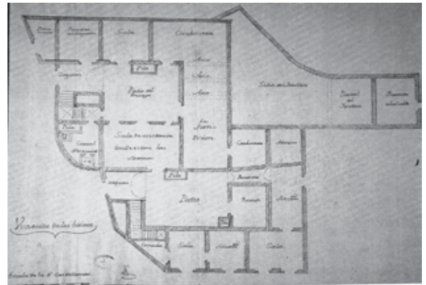
Figura 9. Primer piso de la Casa de Ensaye de Guanajuato, 1783. En la zona donde están marcados los arcos estuvieron el horno de la fundición y su chimenea. AGI, MP, México, 675 y 676. Fotografía de Jorge González Aragón (coord.), Corpus urbanístico de Michoacán... , México, Conaculta-INAH, 2008, p. 107.
