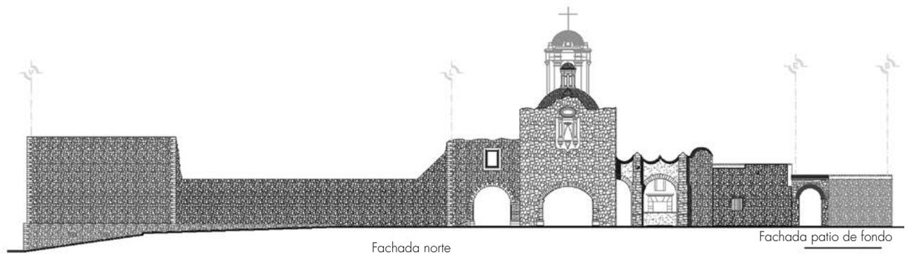
Figura 2. Alzado de la fachada norte. Del lado izquierdo se observa el volumen de las letrinas; también es perceptible la pendiente que se aprovecha para el desalojo de los deshechos.
