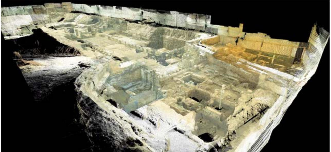
Figura 26a. Perspectiva en nube de puntos con fotografía, obtenida mediante la tecnología de escaneo láser 3D. Laboratorio de Imagen y Análisis Dimensional-CNMH- INAH, México, 2014.
