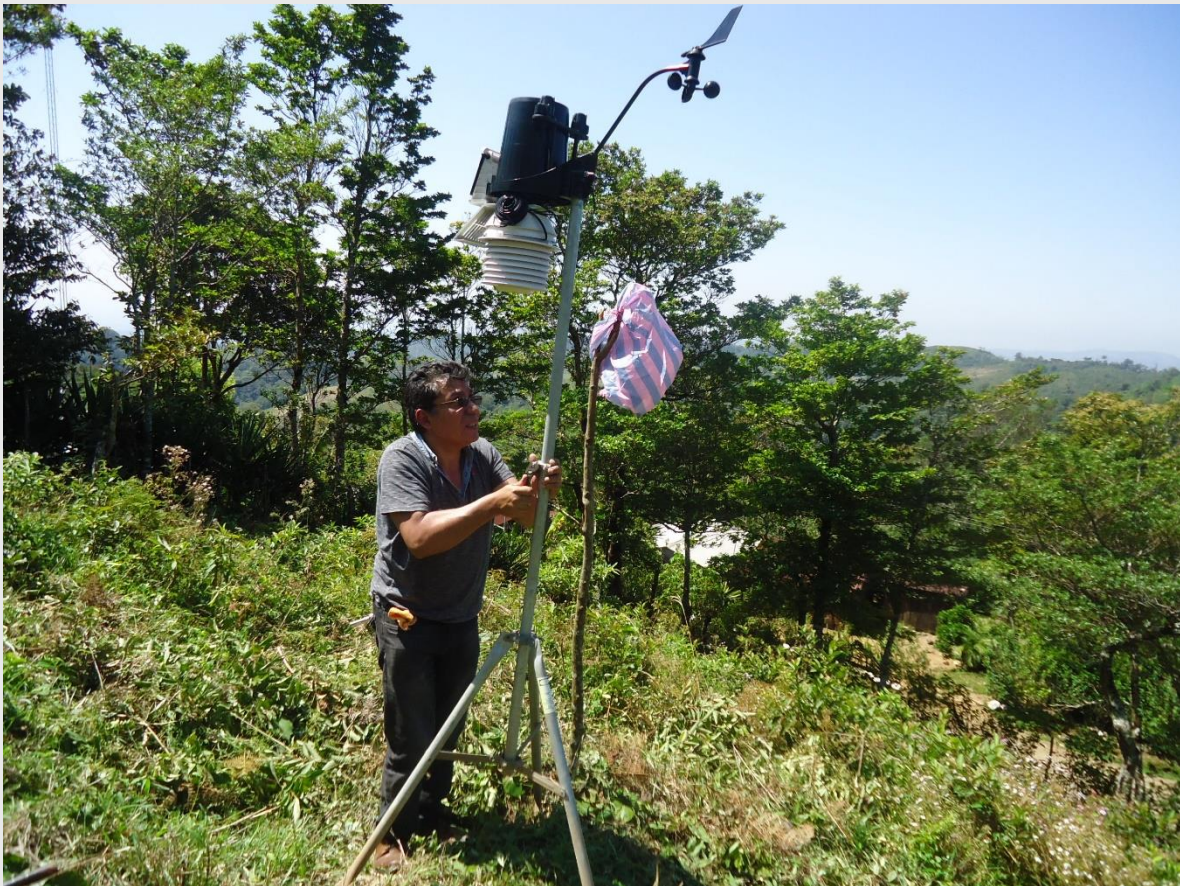
Figura 2. Instalación de estaciones climáticas en el ejido de Plan Agrario, Sotepan, Veracruz. Fotografía: Carlos Robles Guadarrama, 2017.
