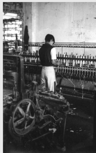
Tróviles y cardas en La Soledad Vista Hermosa, Etl. Foto: Camarena, 1984.
