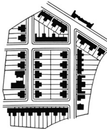
Figura 2. Planimetría de un barrio habitacional unifamiliar según el antiguo sistema. (Del periódico The Garden-City 1909).
