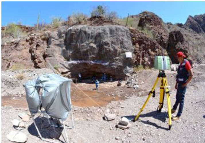
Figura 7. Levantamiento tridimensional con escáner láser del sitio rupestre de Cuevas Pintas. Imagen: Laboratorio 3D de la CNCPC, ©CNCPC-INAH, 2016.
