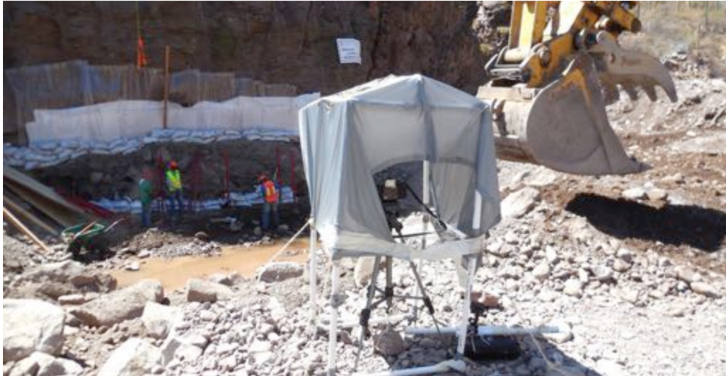
Figura 4. Estación fotográfica para registro general con intervalómetro. Imagen: Sandra Cruz Flores, ©CNCPC-INAH, 2016.
