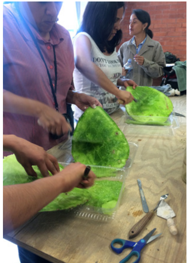
▲ Figura 1. Empleo de mucílago de nopal como aditivo en morteros de cal. Foto: Marlene Sámano Chong. ©INAH
