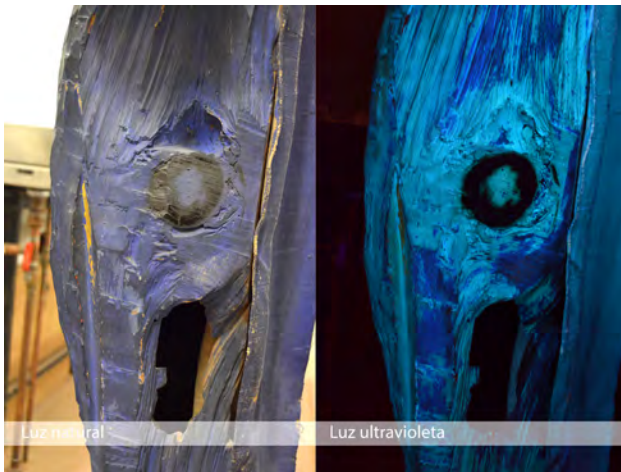
▲ Figura 4 Detalle de quemadura en el nudo de la madera. Izquierda: luz natural; derecha: luz UV.
