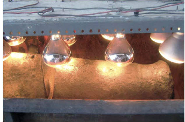
▲ Figura 3. Calentamiento del cañón antes de la aplicación de cera. Imagen: Archivo de la sección de restauración de bienes muebles e inmuebles por destino, Centro INAH Sonora.
