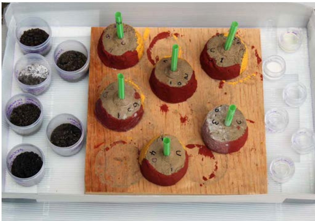
Figura 5. Probetas elaboradas con soporte de tierra y pigmento mineral sobre las que se probaron los materiales clara de huevo, mucílago de nopal, metil celulosa (MC), cola de esturión, hidróxido de calcio, sílice coloidal e hidroxipropil celulosa (HPC). Imagen: ©CNCPC-INAH, 2016.
