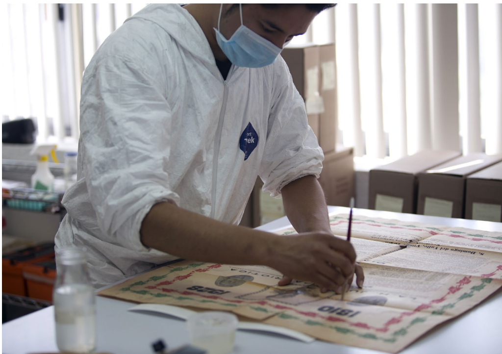
Figura 3. Aplicación de tiras de reactivado de Klucel® G. Trabajo en equipo. Laminado de documento de gran formato. Imagen: ©Fidel Liévana.
